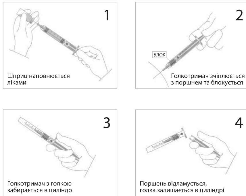
Рис. 1. Схема роботи саморуйнівного одноразового шприца
